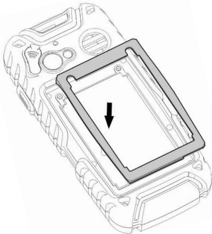
При подъеме крышки батарейного отсека может отойти водонепроницаемая прокладка. Перед установкой крышки верните на место водонепроницаемую прокладку, чтобы гарантировать защиту телефона от воды и пыли (см. рис. слева).
