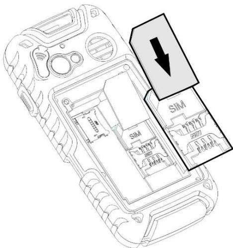
Снимите заднюю крышку. Вставьте SIM карту в слот, как это показано на рис. слева.
