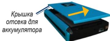
2. Вставьте SIM-карту в слот в верхней части отсека для аккумулятора. SIM-карта вставляется обрезанным углом вперед и лицевой стороной с золотыми контактами вниз.
